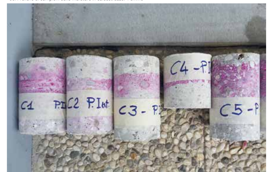
06. Campioni di struttura in calcestruzzo prelevati. 4 emme
