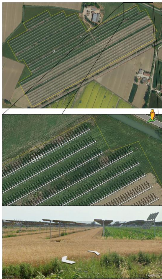
Figura 32. Impianto agrivoltaico elevato ad inseguimento su doppio asse. Comune di Monticelli d'Angina (circa 17 ettari; Piacenza). In basso una vista da Google Street View da cui si nota l'altezza di installazione e la presenza di coltivazioni cerealicole
